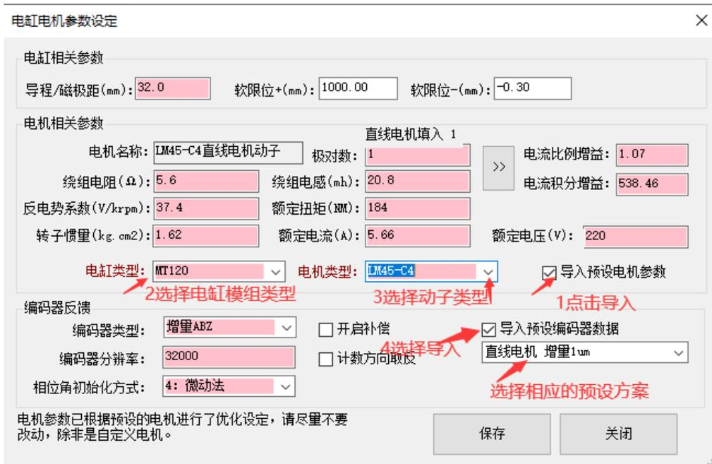
选择好之后，点击“保存”按钮将设定信息保存到驱动器中。要设定生效，需要重启驱动器，点击上位机软件的“重启驱动器”按钮来重启驱动器。
