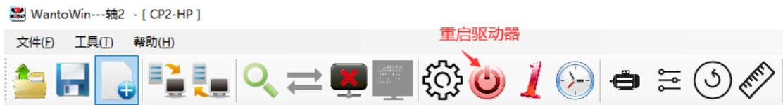
重启之后，确认电机编码器的计数方向是否正确，点击 工具->电机确认，进入点击确认界面。然后点击“开始确认”按钮，进入确认过程。等待确认完成后，软件将自动调整编码器的计数方向，重启驱动器，使得确认信息生效。
